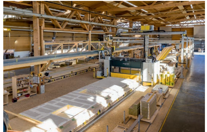
Abb. 2: moderne Produktionslinie einer Holzbauvorfertigung.
