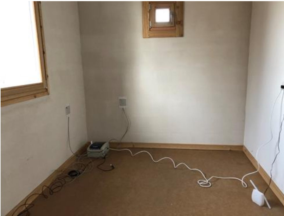
Abbildung 73: Aufbau Wärmestrommessung Mauerwerksgebäude, 2. Obergeschoss
