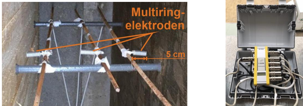
Abbildung 80 Einbaupositionen der MRE an je drei Positionen jeweils an West- und Nordwand vor der Betonage (links). Multiring-Sensorelektronik zum Loggen der Daten (rechts).
