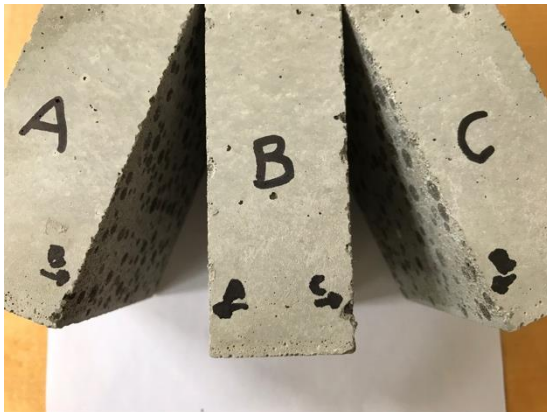
Abbildung 78: Gesägte Proben zur Ermittlung der Wärmeleitfähigkeit, der spezifischen Wärmekapazität (volumetrisch) und der Dichte (links). Infraleichtbetongefüge unter dem Lichtmikroskop (rechts)
