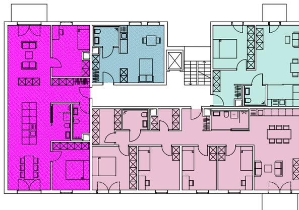
Die Baugruppe NSo- V2 R4 muss in ihrer Breite angepasst werden, um mit den Back to Back angeordneten Typen in der Variante V2 zu funktionieren. Aufgrund der Belichtung der Räume in NSo- V2 R4 funktioniert die Konstellation ‚Spänner 5‘ nur als Endtyp. NSo- V2 Plus3 kann als durchgesteckte Variante in den Mix integriert werden.
