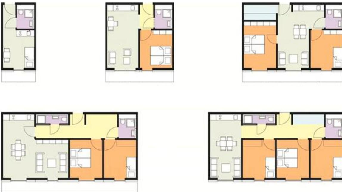
Abbildung 112 Grundrisskonfigurationen der 1-5-Personen Haushalte für das Bausystem Raummodule
