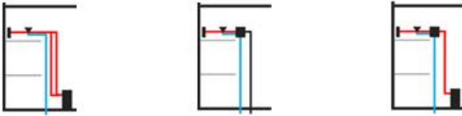
Abbildung 124 Zentrale, dezentrale und semizentrale Wärmeverteilungssysteme
