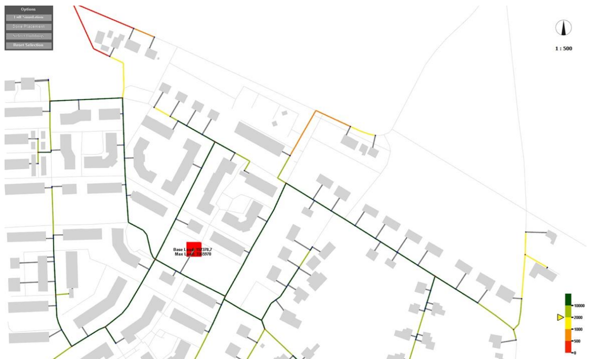
Abb. 4.4 Automatische Generierung und Bewertung des Wärmenetzes in Abhängigkeit der Position der Heizzentrale (physisches Objekt auf der Tischoberfläche – rot markiert)
