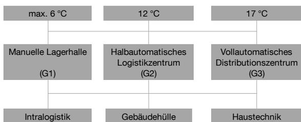
Abbildung 4.12: Kombinationsmöglichkeiten der Temperaturniveaus mit den Untersuchungsmodellen und den Grundelemente der Bereiche Intralogistik, Gebäudetechnik und Gebäudehülle
