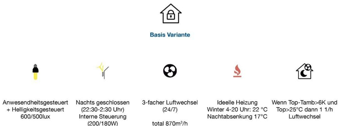
**Abbildung 5.12 Übersicht Simulationsparameter Basisvariante**
