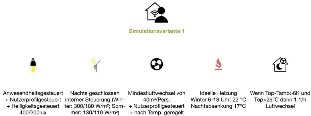
**Abbildung 5.21 Übersicht Simulationsparameter Variante 1**
