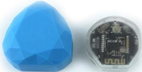
**Abbildung 3.3** Beispiel eines Bluetooth Beacons (nach [7]), links: Umhüllung, rechts: Innenleben
