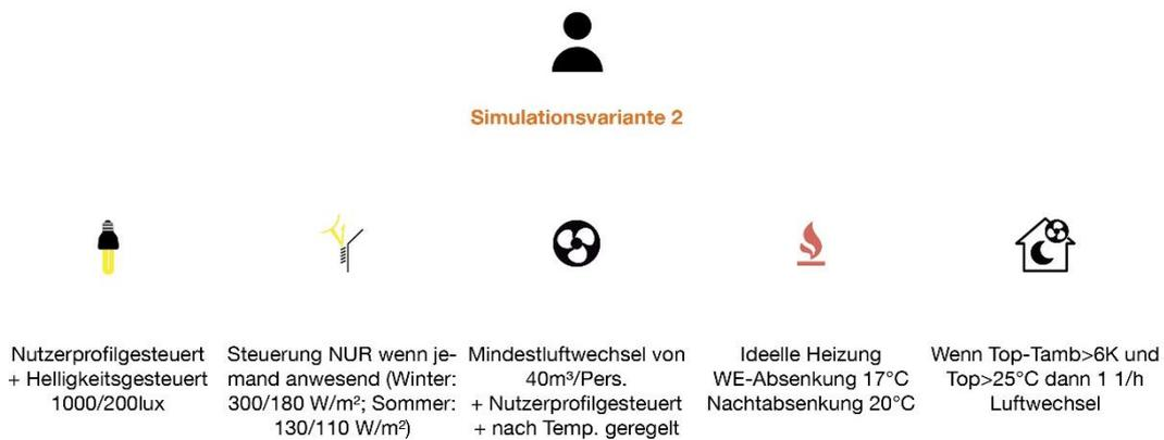
**Abbildung 5.26 Übersicht Simulationsparameter Variante 2**
