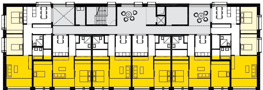
e%-Neu-Ulm: Bei dem kompakten Baukörper werden alle Wohnungen nach Süden orientiert, während die im Norden liegenden Erschließungs- und Kommunikationssflächen als thermische Pufferzone dienen.
