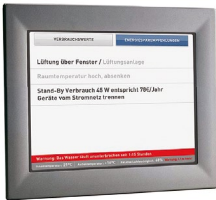
Ein zentrales Bedienelement zeigt die aktuellen Verbrauchswerte von Elektrogeräten, die Raumtemperatur, die Luftfeuchtigkeit sowie einen Hinweis auf einen nicht geschlossenen Wasserhahn.
