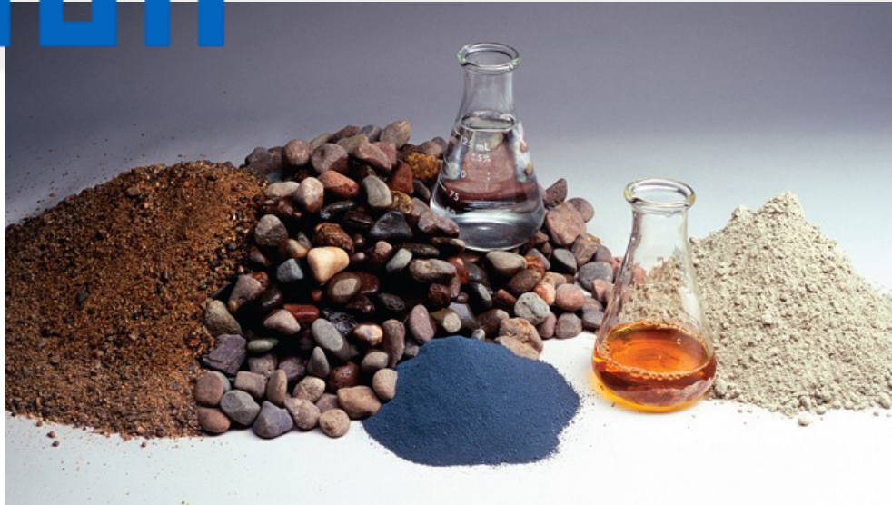
Komponenten für die Betonmischung
