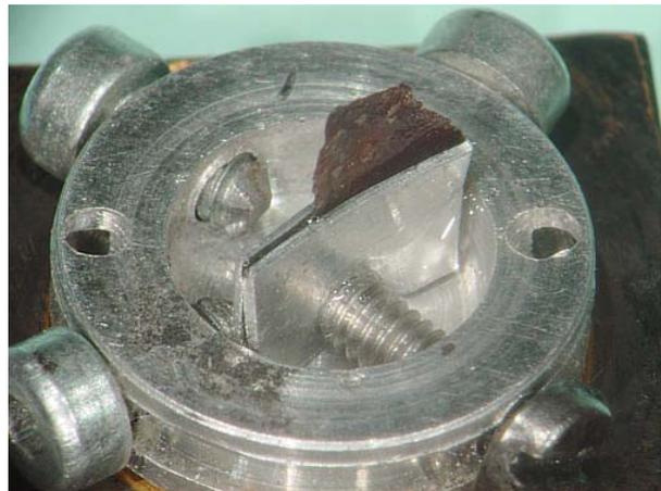
**Abbildung 4.6** für Kryo-REM-Untersuchungen präparierte isolierte Lackscholle
