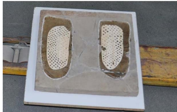
Abb. 90: Fertige Bodenplatte mit doppelten Balsaholzunterlagen
