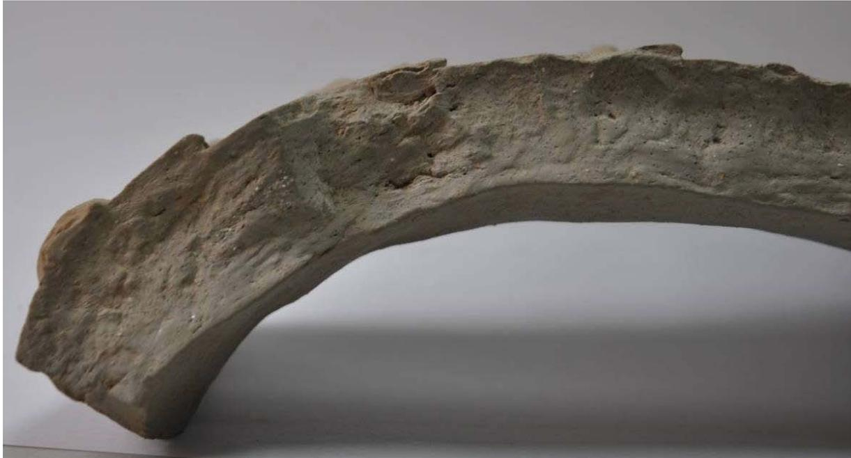
Abb. 20: Stark abgearbeitete, schlecht passende Bruchante (teilweise Ansammlung von Zuschlag)
