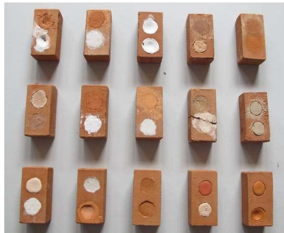
Abb. 93: Versuche zu gefärbten und ungefärbten Ergänzungsmassen in Terrakottaprüfkörpern
