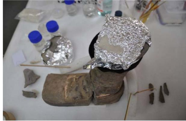
Abb. 82: Herstellung einer Epoxidharzergänzung durch Abtrennung mit Alufolie
