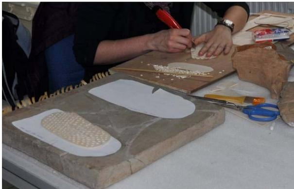
Abb. 89: Herstellung der teils mehrschichtigen Balsaholzunterlagen
