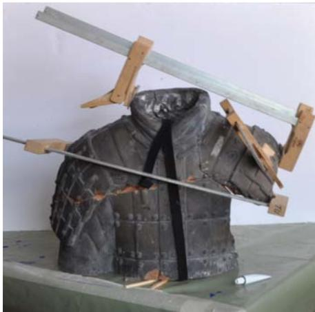
Abb. 16: Teil der Kopie eines Terrakottakriegers während der Einspannversuche
