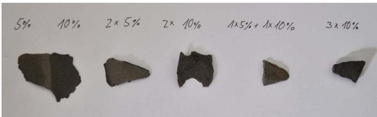
Abb. 17: Anwendungstests mit verschiedenen Primerkonzentrationen von Mowital B30H auf Bruchstücken von Terrakottaziegeln
