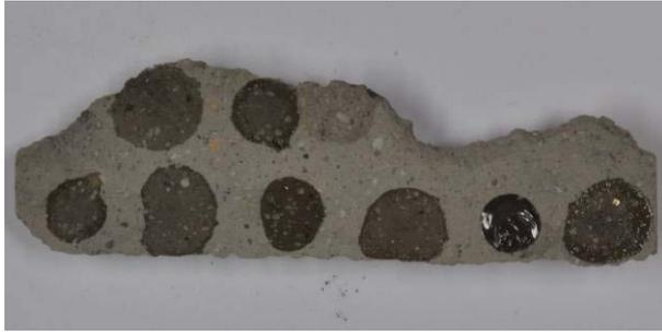
Abb. 11: Lintong-Terrakotta mit aufgetrockneten Tropfen
