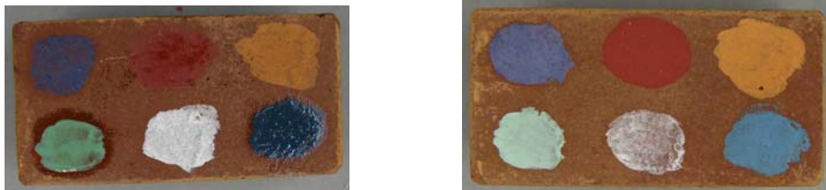
Abb. 15: Proben BO88.2 und BO109.2 (jeweils: chin. Violett, Eisenoxid, Ocker, Malachit, Bleiweiß, Azurit)
