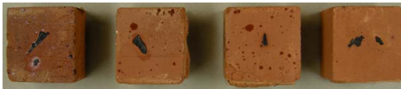
Abb. 9: Gefestigte Lackschollen auf Terrakotta;
