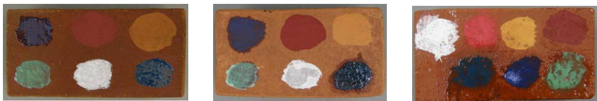
Abb. 16: Proben BO109.5, BO109.1 (jeweils: chin. Violett, Eisenoxid, Ocker, Malachit, Bleiweiß, Azurit) und BO33.5 (Bleiweiß, Zinnober, Ocker, Eisenoxid, Azurit, chin. Violett, Malachit)
