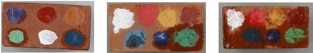
Abb. 13: Proben BO88.1 (zeilenweise: chin. Violett, Eisenoxid, Ocker, Malachit, Bleiweiß, Azurit), BO33.1 und BO33.2 (jeweils zeilenweise: Bleiweiß, Zinnober, Ocker, Eisenoxid, Azurit, chin. Violett, Malachit)
