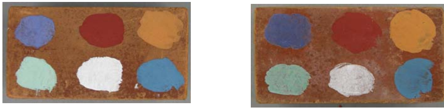
Abb. 14: Proben BO88.3 und BO109.3 (jeweils: chin. Violett, Eisenoxid, Ocker, Malachit, Bleiweiß, Azurit)
