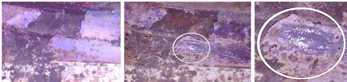
**Abbildung 39. Detail von Fragment F009/98, a) Aufnahme nach der Festigung im Dezember 1998, b) Aufnahme vom März 2000, c) Detail von b) Glanzfleck nach einjähriger Lagerung**
