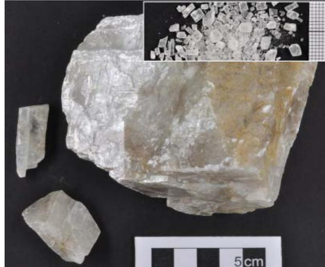
Abb. 3: Kluftcalcit, farblos bis transparent (Brilon, Deutschland). Deutlich sind die glatten Spaltflächen zu erkennen sowie die rhomboedrische Kristallstruktur.
