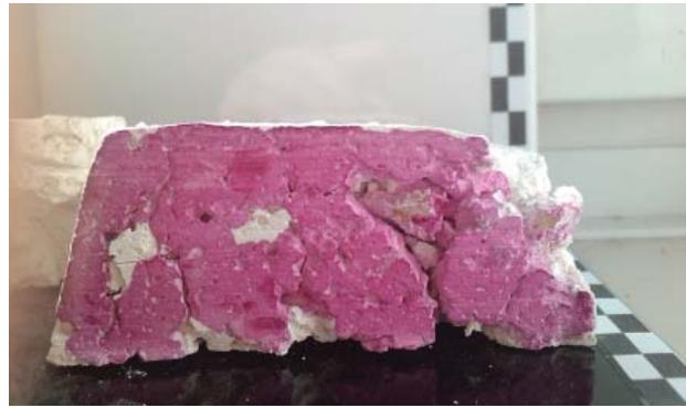
Abb. 17: Stuckmasse, mit Aluminium geschäumt (mit trockenge-löschtem Kalk)
