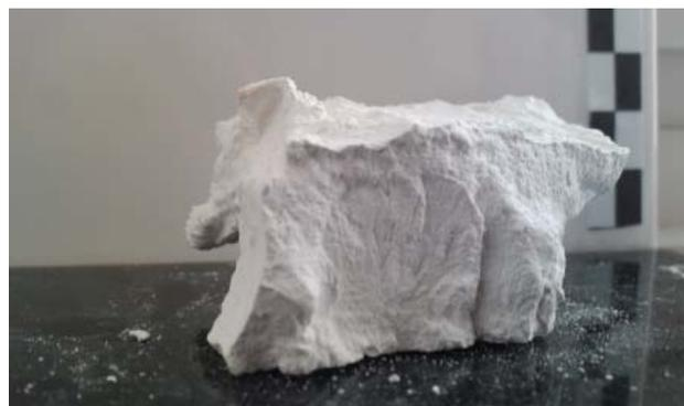
Abb. 25: Trockengelöschter Kalk mit Milch
