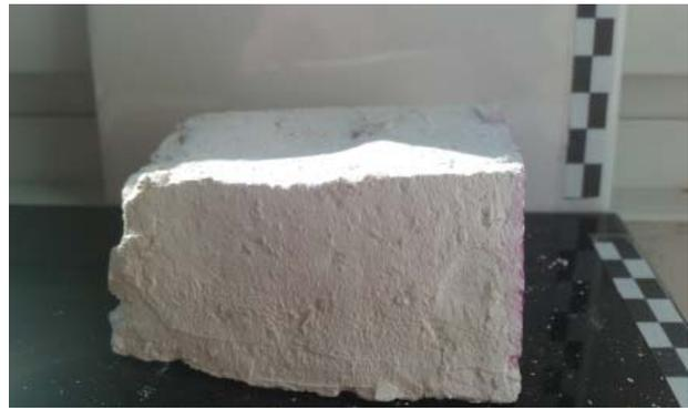
Abb. 19: Stuckmasse, mit Aluminium geschäumt (mit trockenge-löschtem Kalk)
