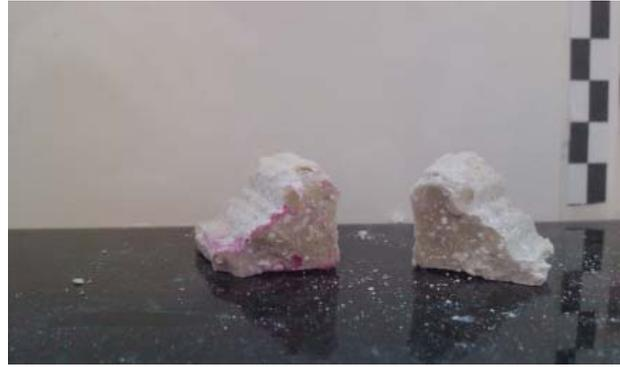
Abb. 21: Trockengelöschter Kalk mit Essigsäure
