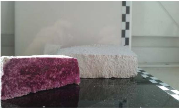
Abb. 16: Stuckmasse, mit Aluminium geschäumt (mit Sumpfkalk).
