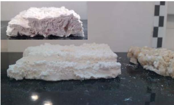
Abb. 22: Sumpfkalk mit Essigsäure 5 : 1
