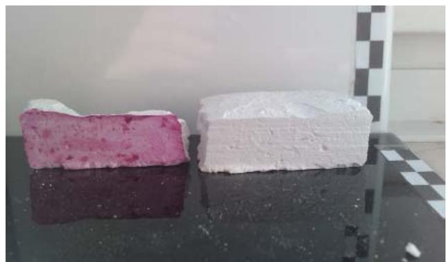
Abb. 15: Mischungsverhältnis Trockengelöschter Kalk : Sumpfkalk 1: 1
