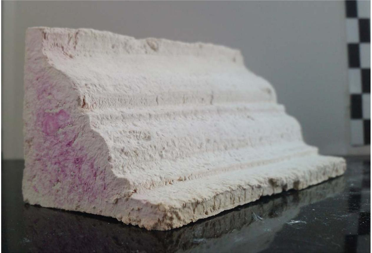
Abb. 32: Gezogenes Stuckgesims entsprechend Rezeptur der Versuchsreihe 10
