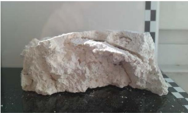
Abb. 18: Stuckmasse, mit Aluminium geschäumt (mit Sumpfkalk).
