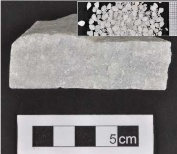
Abb. 2: Marmor (Carrara, Italien). Die Bruchfläche zeigt das feinkörnige Gesteinsgefüge, welches beim Zerkleinern in eher runde Sandkörner zerfällt.
