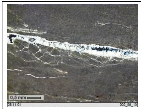
Abb. 26: Aufgefiedertes Gefüge durch feines Rissystem entlang der Dehnungsklüfte (SA-002-99)
