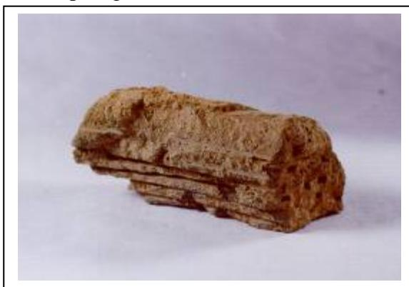
Abb. 1: Tonmodell zur Herstellung der Verknüpfungsdrähte (Längsschnitt)
