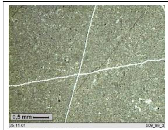
Abb. 5: Gekreuzte Kluftfüllung der genetisch bedingten Entlastungsrisse (SA-008-99)
