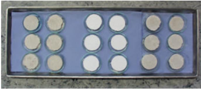
*Abb. 10: Tränkung der gepressten Prüfscheiben*
