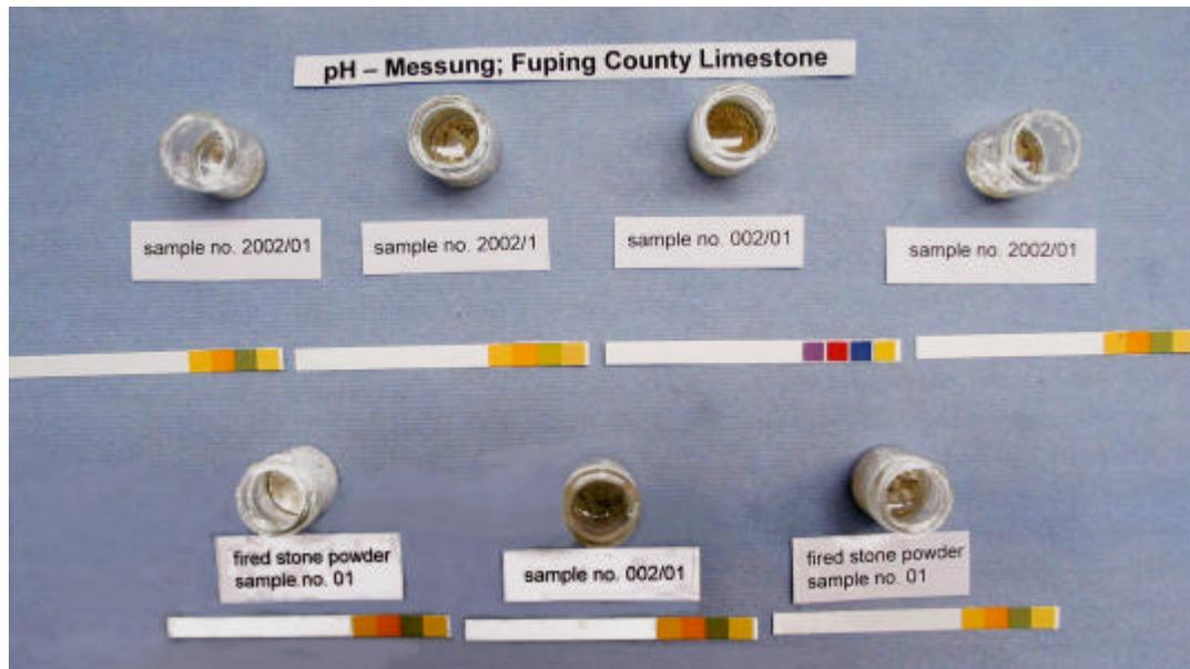
Abb. 10: Überprüfung der Restalkalität
