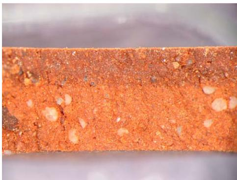
Abb.2: Mit der Elektronenstrahlmethode behandeltes Plättchen 2
