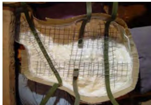
**Abb. 10:** Panzerseite mit mehreren Schichten CCD, Metallarmierung und Tragegriffe
