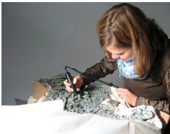
Abb. 13: Reinigung mit Ultraschallmeißel
