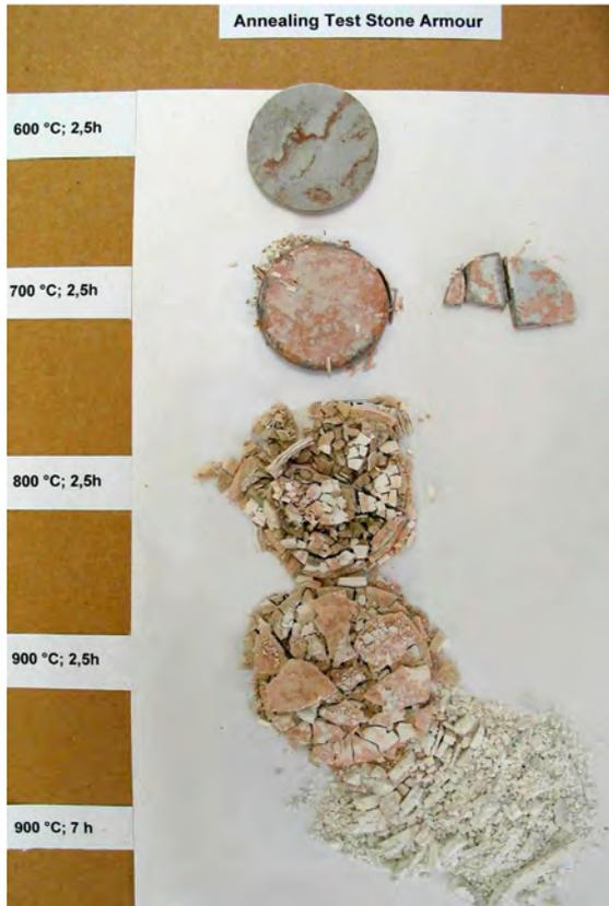
Abb. 3: Versuch zur Herstellung gebrannter Kalksteindummies (links)
