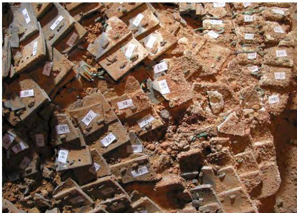
**Abb. 3:** Schaden durch Feuereinwirkung: Vorderseite und Rückseite des Panzers sind miteinander „verbacken“.
