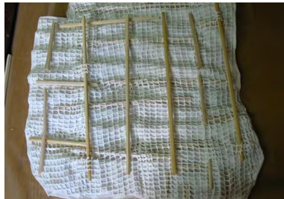
**Abb. 6:** Versteifung mit Bambusstäbchen
