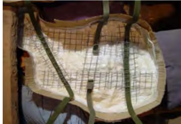
**Abb. 10:** Panzerseite mit mehreren Schichten CCD, Metallarmierung und Tragegriffe
