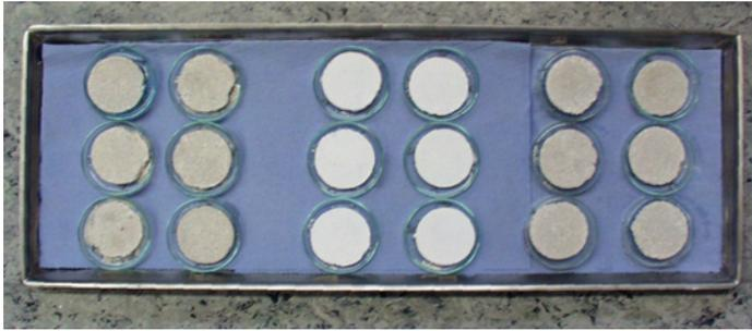
*Abb. 10: Tränkung der gepressten Prüfscheiben*
