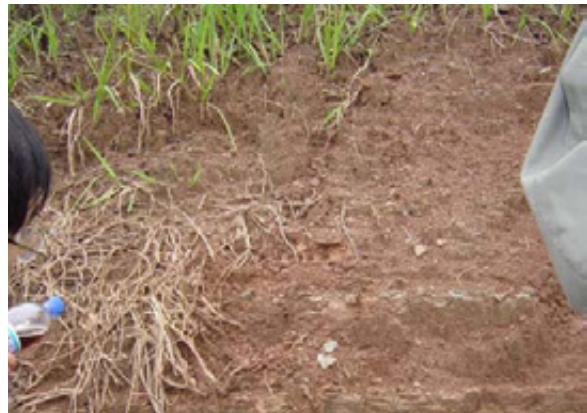
**图 2-9 泥岩风化形成残积土
