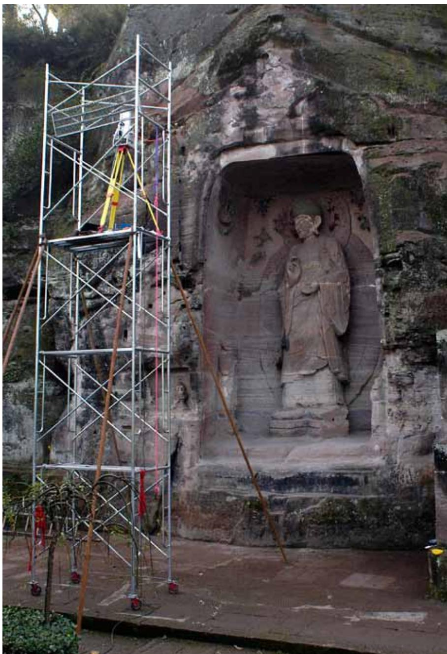
**Abb. 3:** Vermessung der Grotte Nr. 10 mit dem Riegl-Laserscanner auf dem fahrbaren Gerüst mit Stützkonstruktion
