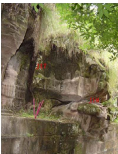
图 2-19 卸荷裂隙 J<sub>17</sub> 和 J<sub>18</sub>
