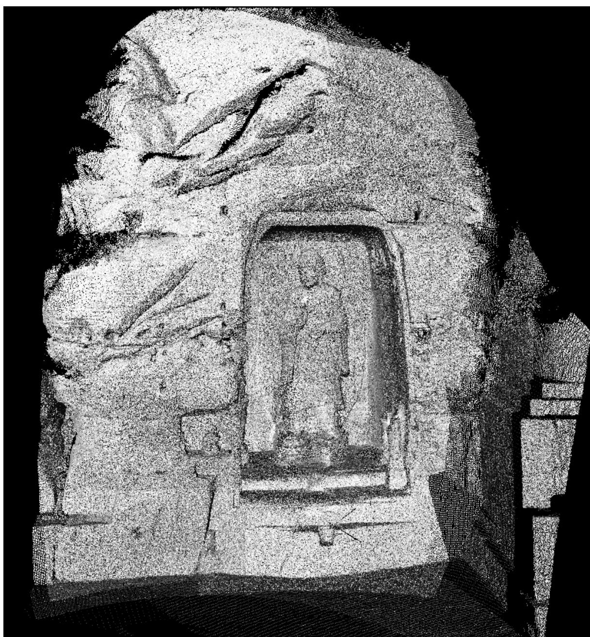
**Abb. 14:** Gesamtpunktwolke: Kombination der Laserscanner- und Streifenlicht-Aufnahmen mit QT-Sculptor an Grotte Nr. 10
