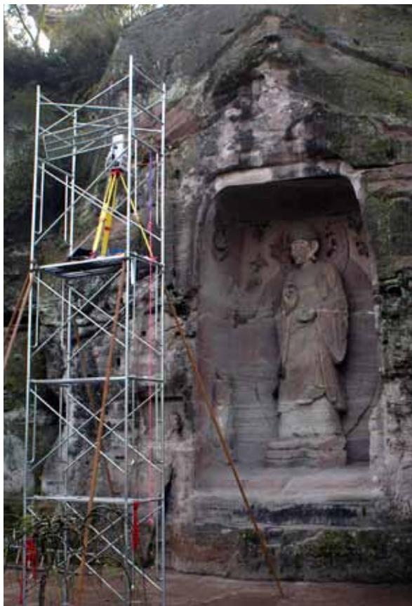
**Abb. 4:** Vermessung der Grotte Nr. 10 mit dem Riegl-Laserscanner
