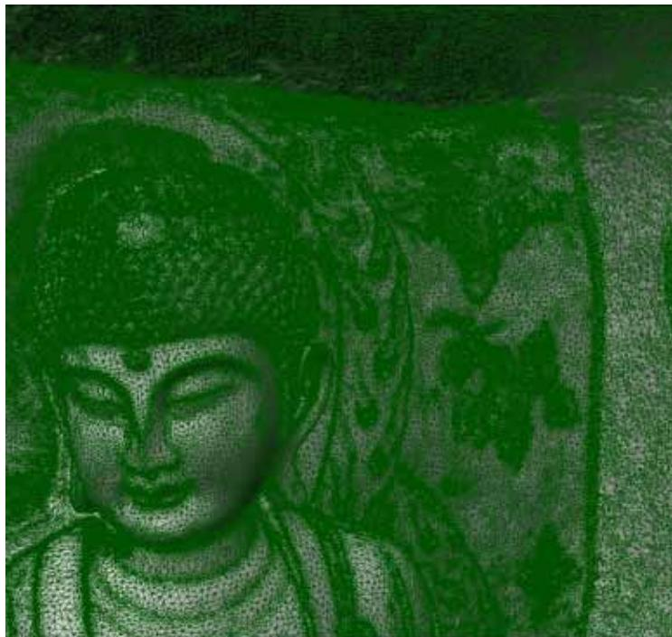
**Abb. 16:** Dreiecksvermaschung aus Laserscanner- und Streifenlichtdaten im Detail (schattierte Ansicht oben und Gitternetz unten)
