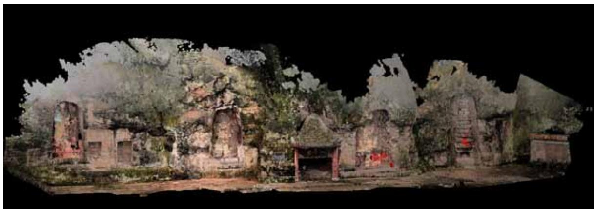
**Abb. 13:** Kolorierte Gesamtpunktwolke aller Standpunkte des Laserscanners
