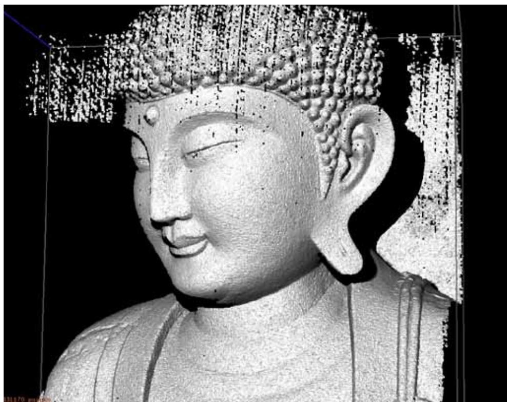
**Abb. 8:** Ansicht der beim Scannen entstandenen Punktwolke, Aufnahme mit QT-Sculptor
