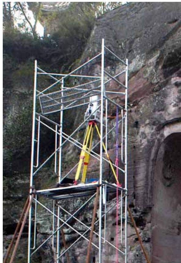
**Abb. 5:** Messungen innerhalb der Grotte Nr. 10 mit dem Riegl-Laserscanner
