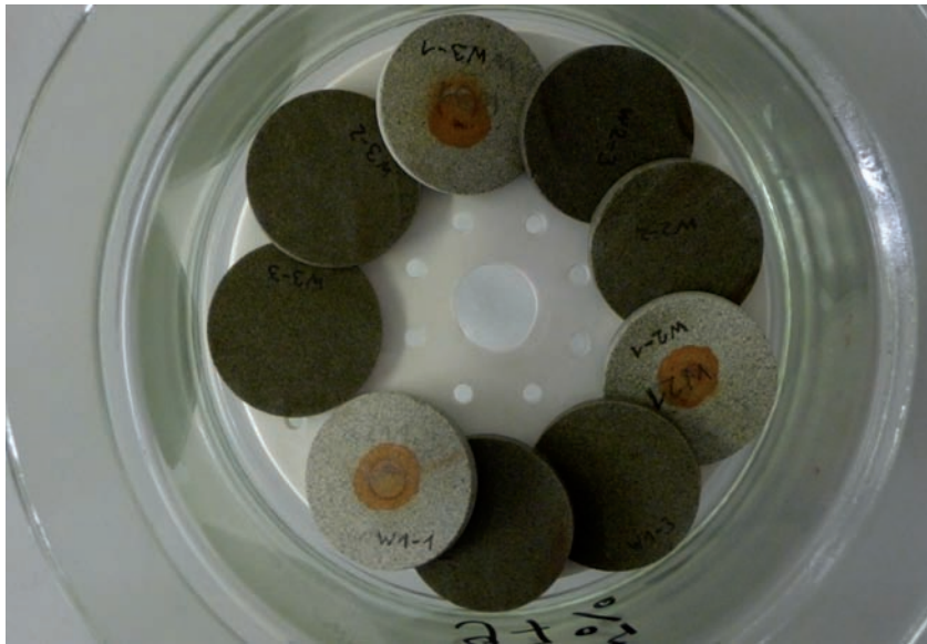
Abb. 13: Die unbehandelten Proben W1, W2 und W3 im Exsikkator bei 97 % relativer Luftfeuchte. Die Scheiben 1-1, 2-1 und 3-1 sind trocken, die Scheiben 1-2, 1-3, 2-2, 2-3, 3-2 und 3-3 sichtbar nass /
