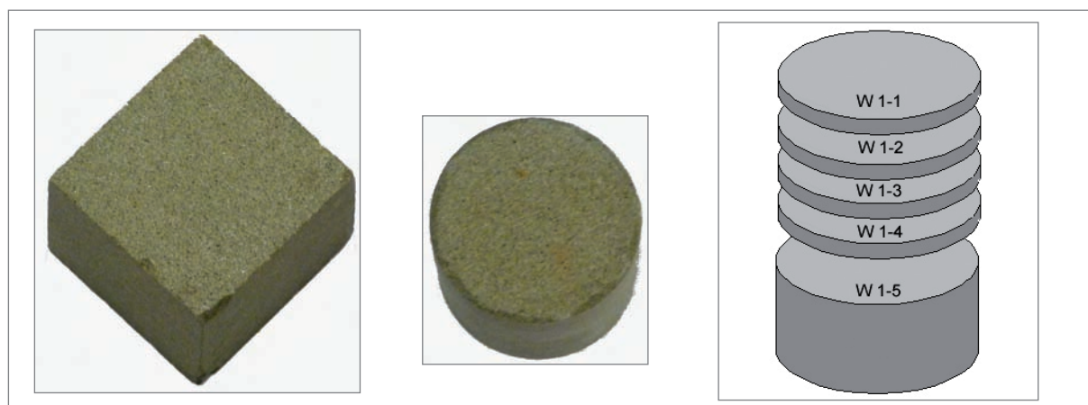
Abb. 8: Veränderung der Probengröße und schematische Darstellung der Beschriftung / Fig. 8: Alteration to sample size and illustration of labelling
