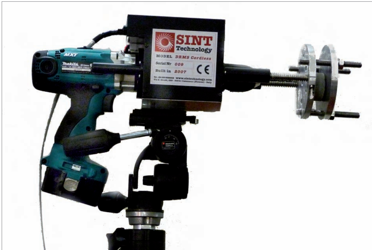
Abb. 6: DRMS-Gerät der Fa. Sint mit Einspannvorrichtung zur Bohrhärtemessung von Materialproben / Fig. 6: DRMS machine from the company Sint
